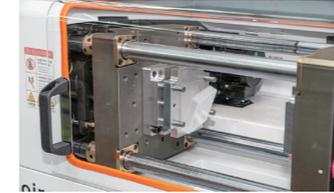
材料を溶かして圧力をかけ、冷やしながら固めて容器の形を作っていきます。
